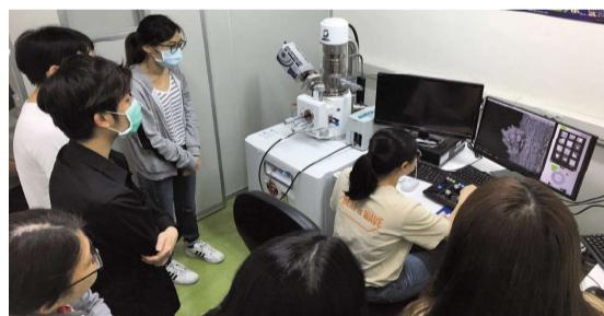
掃描式電子顯微鏡實做，讓同學可以配合課程，透過實際操作，更瞭解如何使用掃描式電子顯微鏡，觀察奈米材料的細微結構、樣品的前處理方法，以及樣品聚焦和拍攝技巧。
